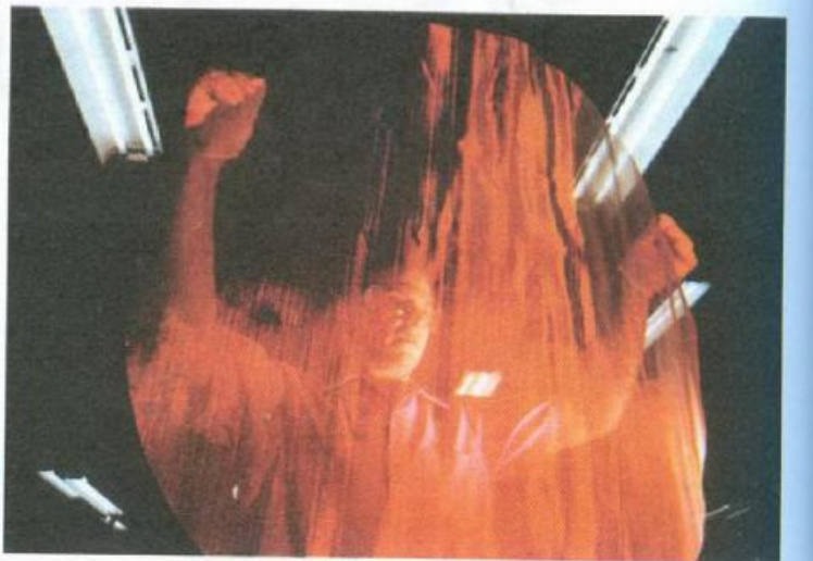
شکل ۳۳-۴. یک توری پلاتین-رودیم که به عنوان کاتالیزگر در تولید صنعتی نیتریک اسید به کار می رود.
