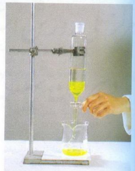
شکل ۱۸. ۷. جدا کردن آب و نفت با استفاده از یک قیف جداکننده. برای وضوح بیش تر، به آب، رنگ افزوده شده است.
